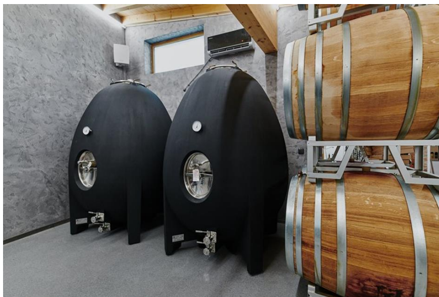
Obrázek 6. Betonové vinařské tanky vejčitého tvaru vedle klasických sudů
