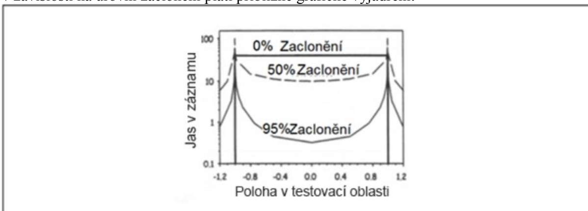
Obr. 7. - Vliv polohy objektu v detekční oblasti. Charakteristika převzata z [74].
