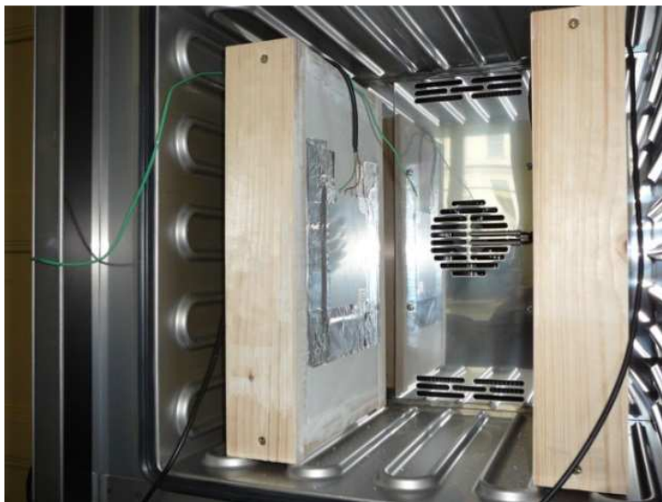
Obr. 7 Vzorky omítky v tepelném inkubátoru
