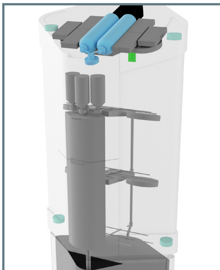
Obr. 8-8 Umístění nádob s \text{CO}_2 , \text{CO}_2 metru a regulačních ventilátorů
