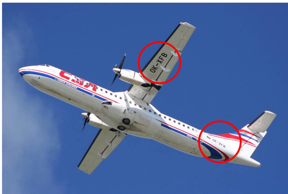
Obr. 5.7 Poznávací značka umístěna na spodní ploše křídla a trupu u letounu ATR 72-200 [39]
