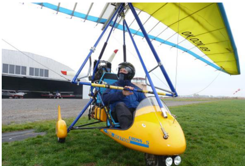
Obr. 5.10 Poznávací značka motorového závěsného kluzáku Air Création – TANARG umístěná na spodní ploše křídla [47]
