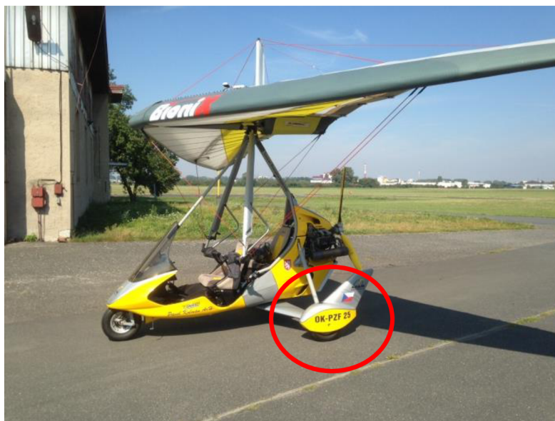
Obr 5.9 Poznávací značka motorového závěsného kluzáku umístěná na boční straně podvozku [46]
