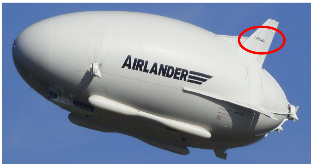
Obr. 5.4 Poznávací značka na vertikálním stabilizátoru vzducholodě Airlander 10 se státní příslušnosti Velké Británie [42] 2
