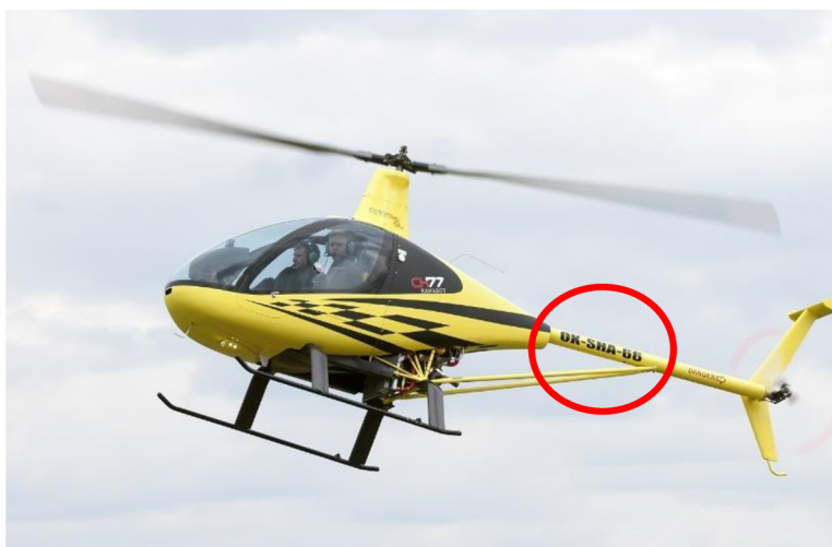
Obr. 5.12 Poznávací značka ultralehkého vrtulníku FLY CC III umístěná na trupu [49]
