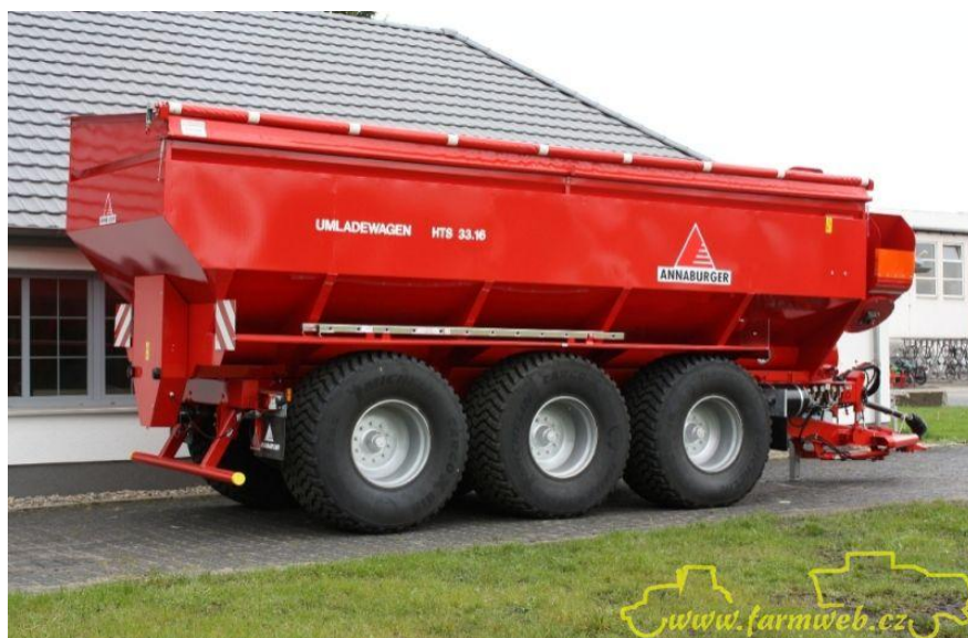
Ilustrace 14: Překládací přívěs s floatačními pneumatikami
