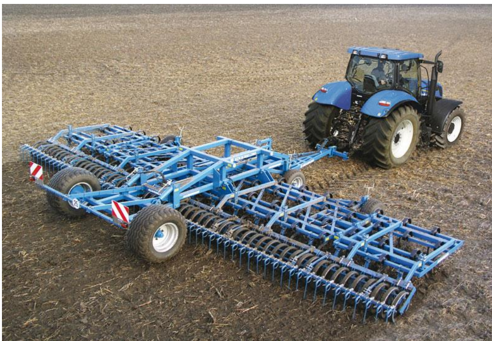
Ilustrace 21: Köckerling Allrounder se záběrem 12 metrů
