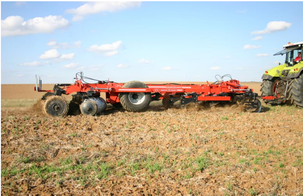
Ilustrace 22: Diskový podmítač Gregoire Besson s podrýváním o záběru 8 metrů
