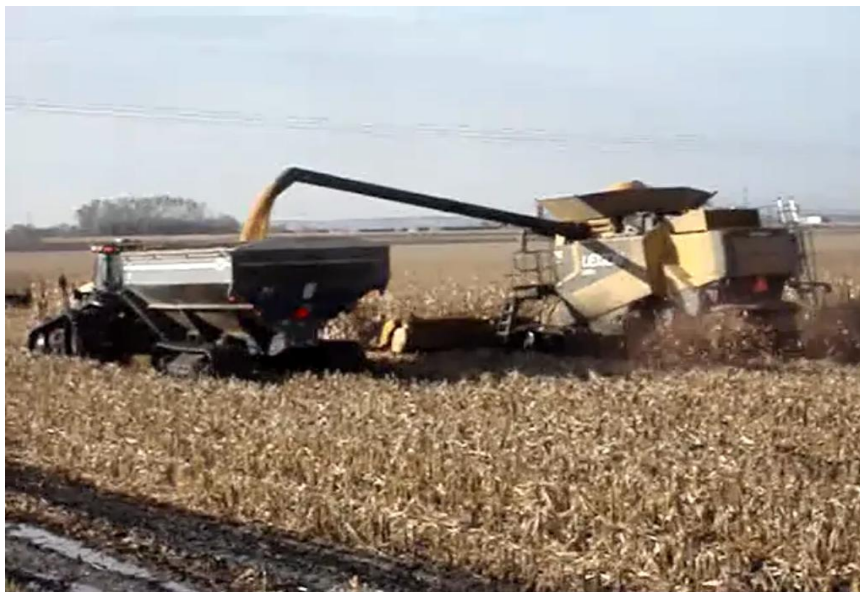
Ilustrace 15: Překládací přívěs na pásovém podvozku
