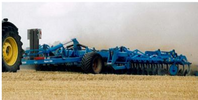
Ilustrace 20: Lemken Rubin 9 se záběrem 8 metrů
