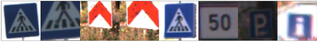
Obr. 6.3: Príklady falošne pozitívnych detekcií zo siete R-Net, obsahujúce značky nezahrnuté do klasifikácie.
