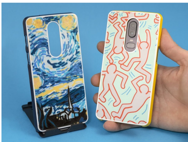
Obr. 2.4: Multimateriální výtisk pomocí více tiskových úloh [17]
