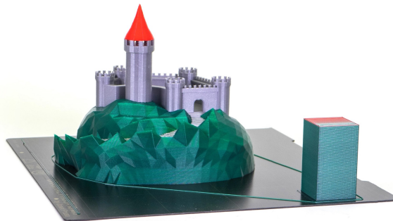
Obr. 2.6: Multimateriální výtisk a čistící věž [19]
