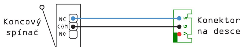
Obr. 5.2: Schéma zapojení mechanických koncových spínačů
