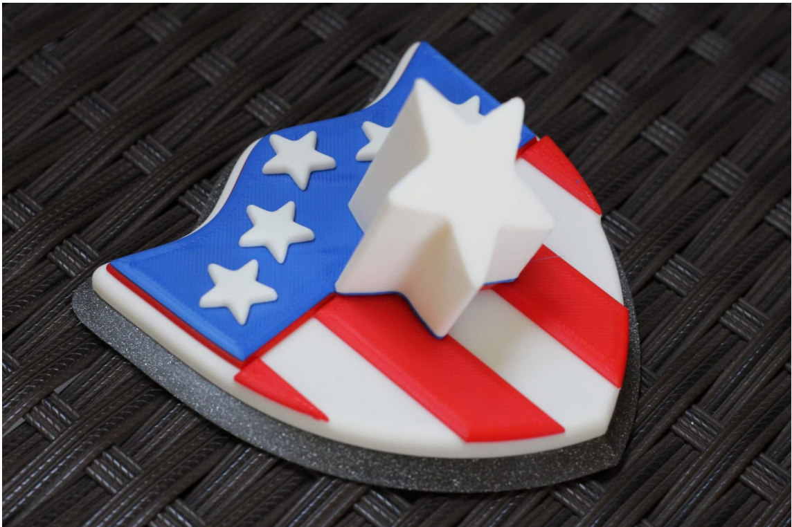
Obr. 2.3: Multimateriální výtisk pomocí změny filamentu mezi vrstvami [16]
