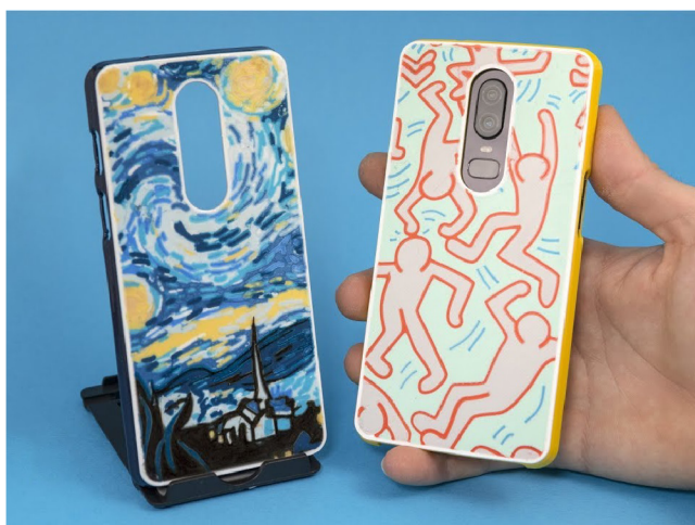
Obr. 2.4: Multimateriální výtisk pomocí více tiskových úloh [17]
