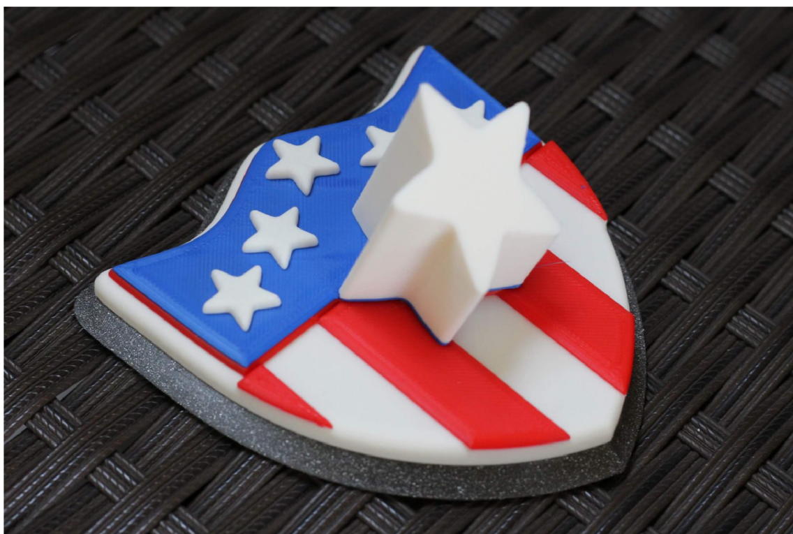
Obr. 2.3: Multimateriální výtisk pomocí změny filamentu mezi vrstvami [16]
