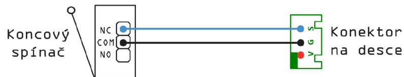
Obr. 5.2: Schéma zapojení mechanických koncových spínačů
