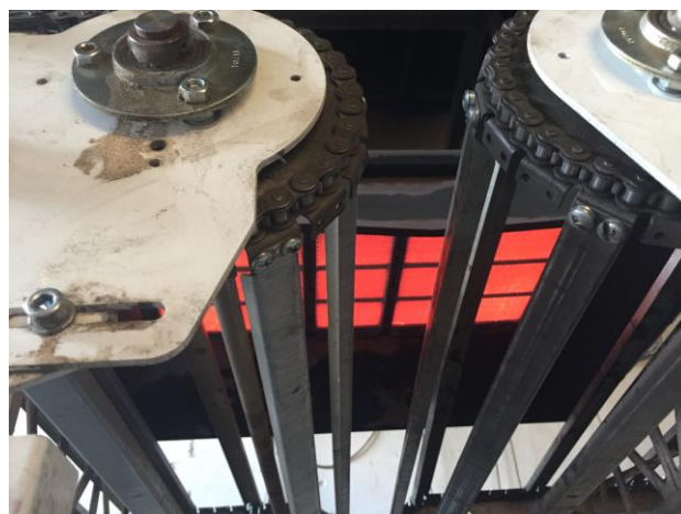
Obrázek 17 Zapnutý hořák na opalování dřeva (zdroj: autor).
