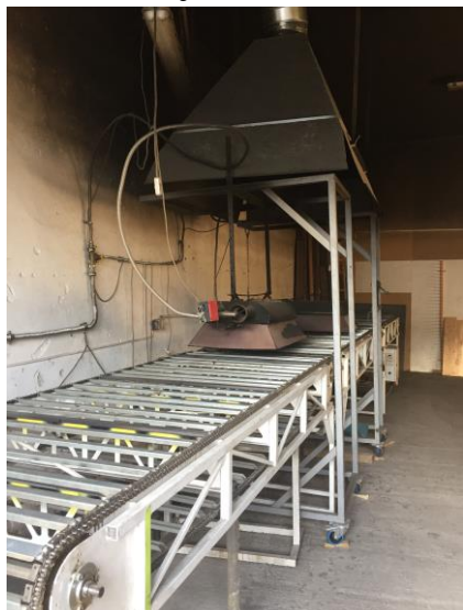
Obrázek 16 Dopravník na opalování dřeva (zdroj: autor).
