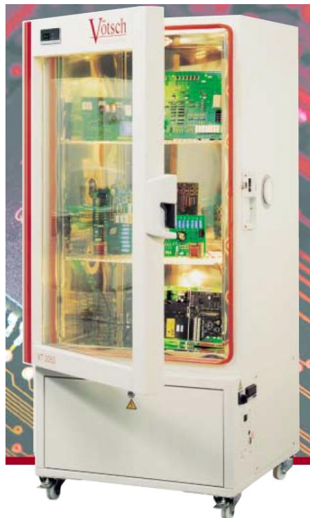
Zkušební systém pro testování součástek VT 3050 (převzato z [14])
