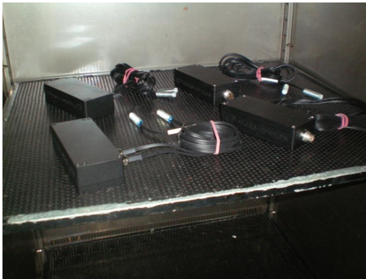
Systemy DBS 5908 umístěné ve vypalovací peci
