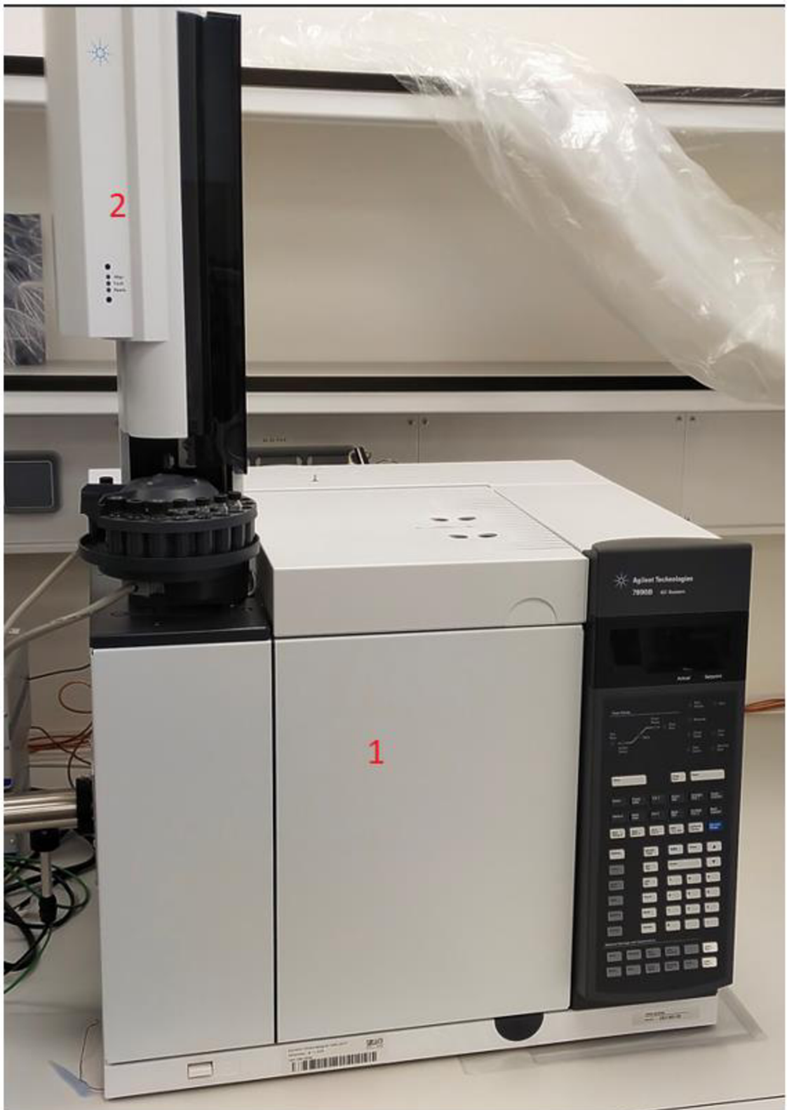
Obrázek 15. Detailní pohled na plynový chromatograf (1) s automatizovaným injektorem zkoumaných látek (2).
