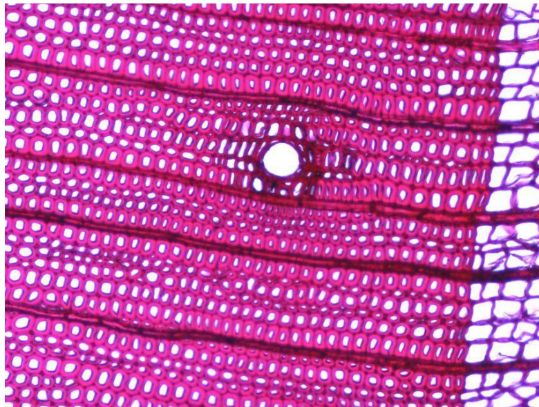
Obrázek 6 Mikroskopická stavba douglasky – příčný řez (Zeidler a Böhm 2007)
