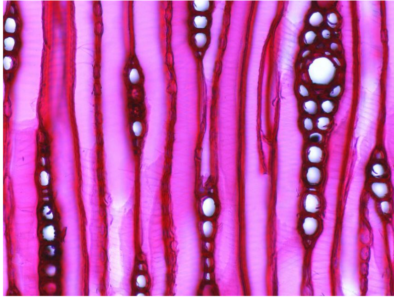
Obrázek 7 Mikroskopická stavba douglasky – tangenciální řez (Zeidler a Böhm 2007)
