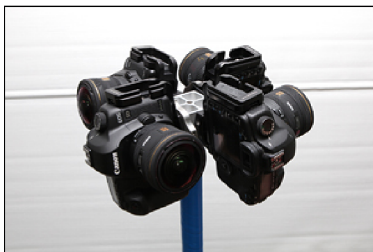
Obrázek 2.2: Zařízení firmy Airpano pro snímání VR videa. (Převzato z [25])
