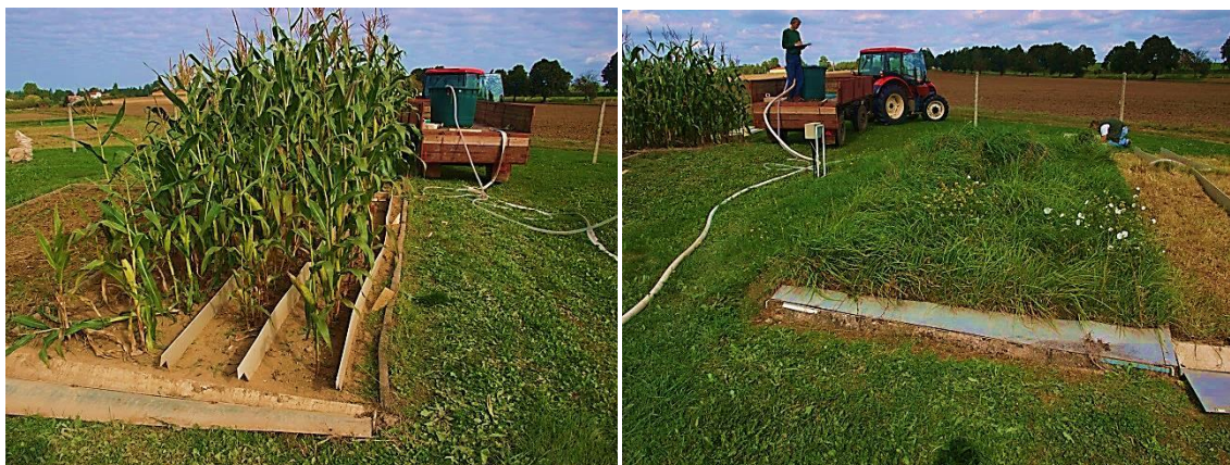
Obr. 30 Příprava na měření rychlosti postupu přeronové vlny v porostu kukuřice (vlevo) a v TTP (vpravo) foto S. Hejduk
