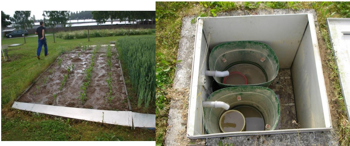
Obr. 27 Počátek povrchového odtoku na variantě s kukuřicí (vlevo) a detail záchytné nádrže při měření odtoku (vpravo) 16. 6. 2011 - foto autor
