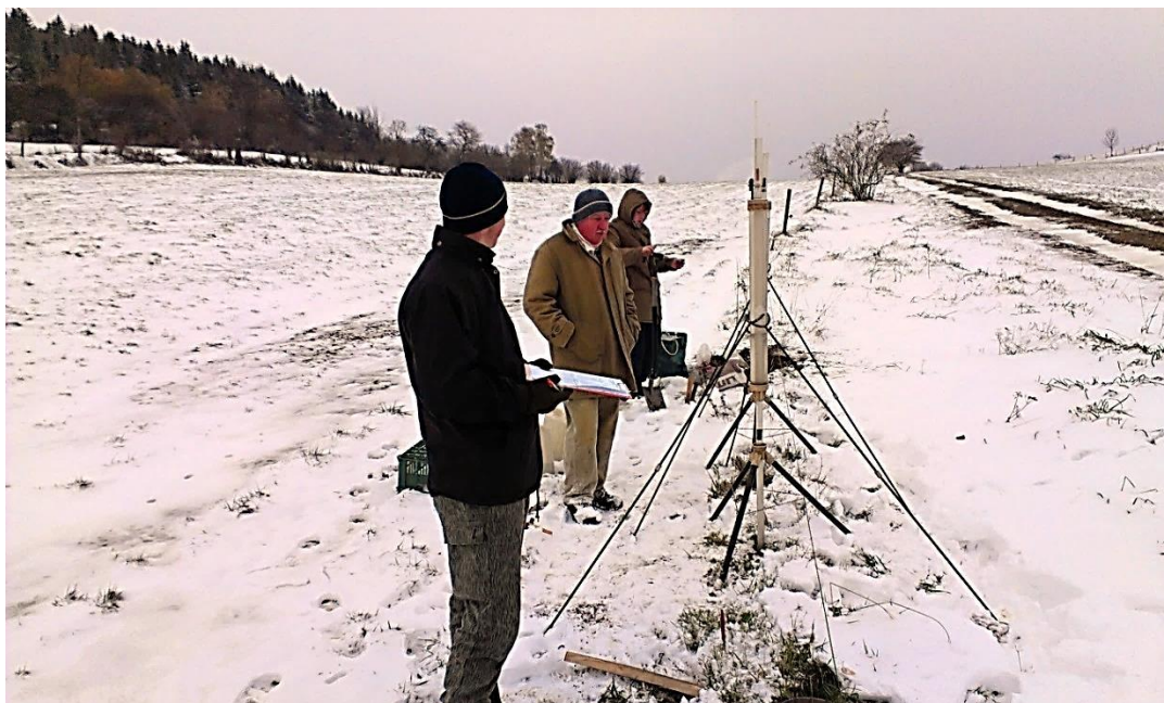
Obr. 23 Měření Guelphským permeametrem na konci vegetačního období (11. 10. 2012, foto autor)
