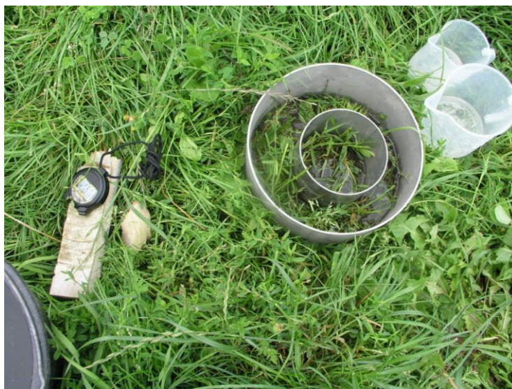
Obr. 19 Pomůcky pro měření infiltrace pomocí metody soustředných válců (foto S. Hejduk)
