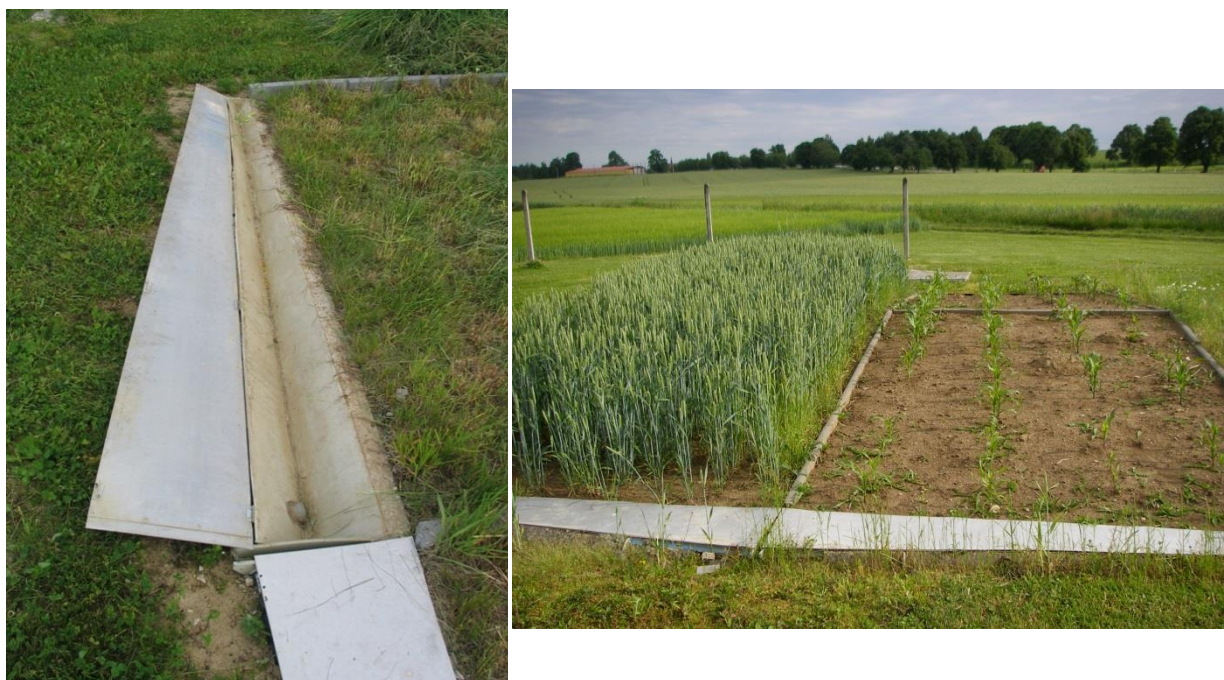
Obr. 26 Detail záchytného žlábků (vlevo) a pohled na jižní expozici odtokoměrných ploch (vpravo) - foto autor
