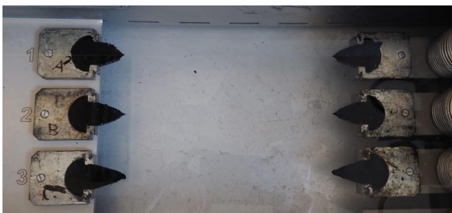
Obrázek 26 – Zkouška vratné ductility – křehké porušení vzorků
