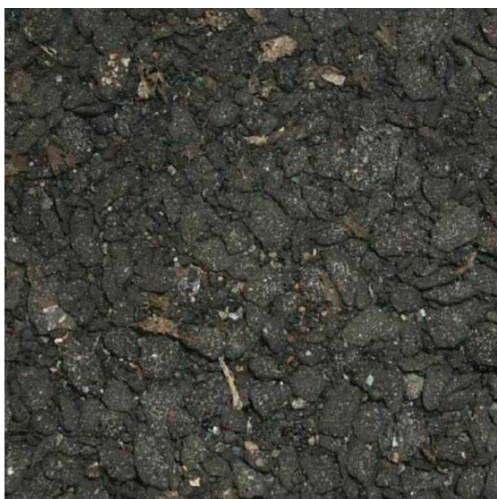
Obrázek 4 – Asfaltové šindele – odpad z výroby [9]
