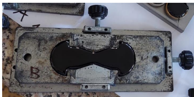
Obrázek 19 – Forma pro zkoušku vratné duktility naplněná asfaltovým pojivem
