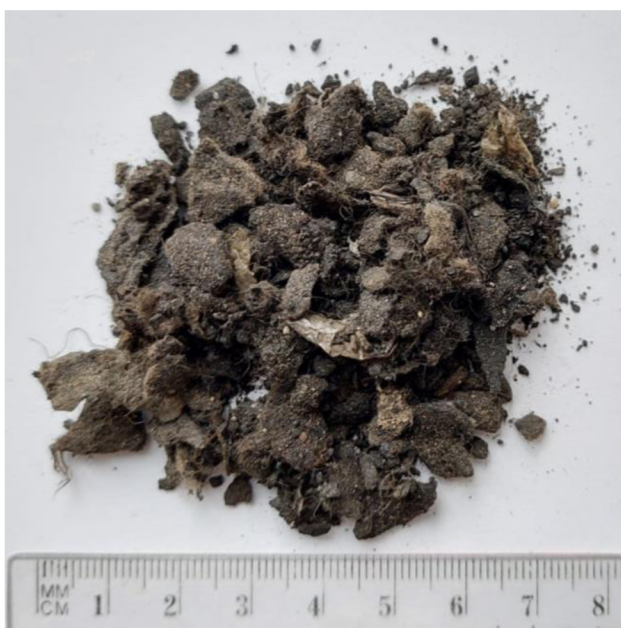
Obrázek 25 – Šindel – dovoz ze zahraničí (vzorek C)
