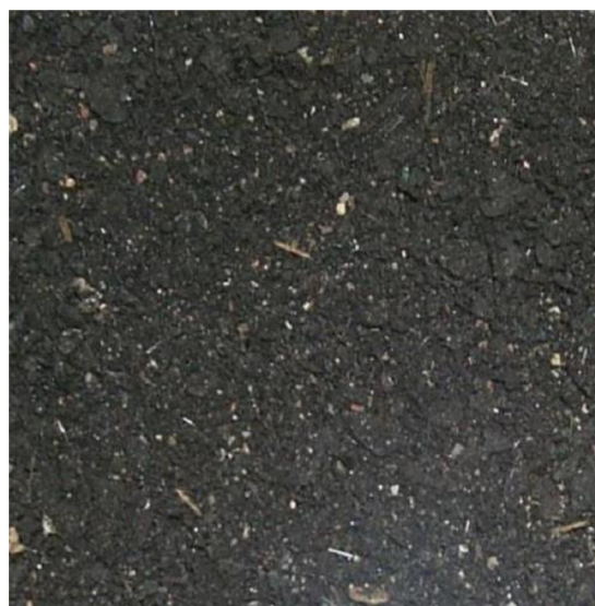
Obrázek 5 – Asfaltové šindele – odpad ze střechy [9]
