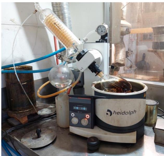
Obrázek 9 – Rotační vakuové destilační zařízení
