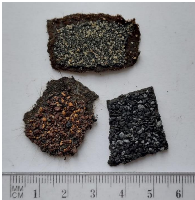
Obrázek 24 – Šindel – odpad z výroby (vzorek B)
