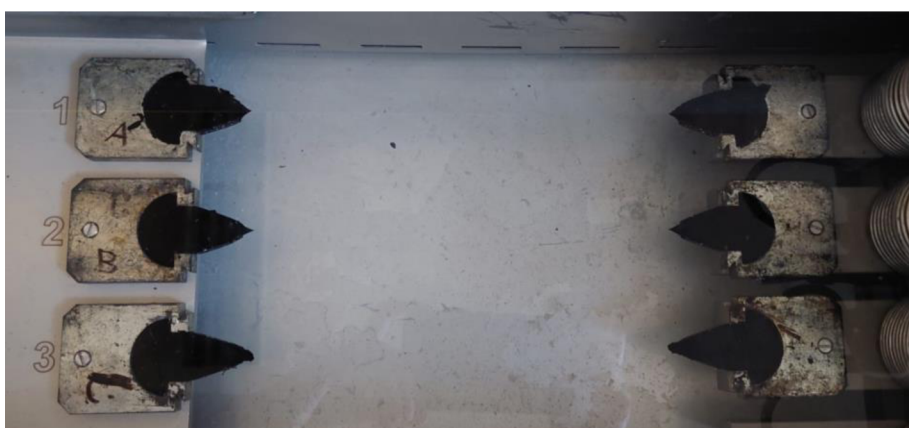
Obrázek 26 – Zkouška vratné ductility – křehké porušení vzorků
