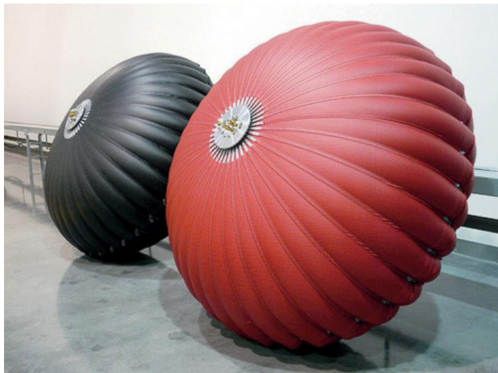
Obr. 9 Pružné vaky pro skladování pod mořskou hladinou [17].
