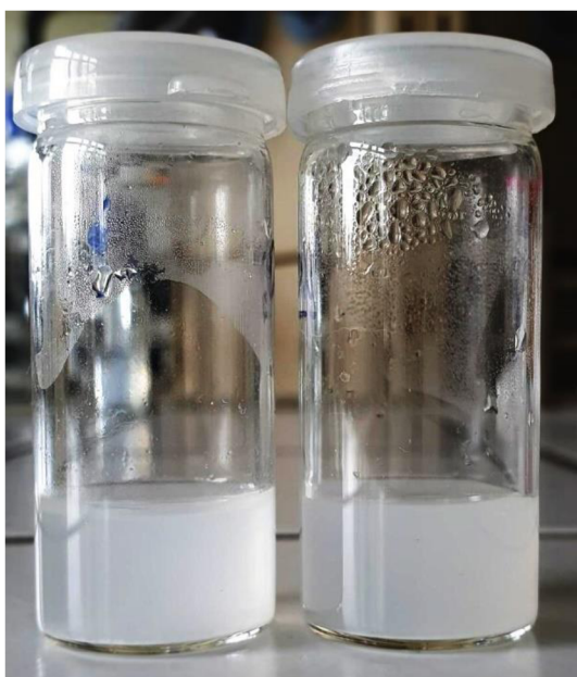
Obrázek 17: Komplex DOTAP +DPPC + Cholesterol po sonifikaci v ultrazvukové lázni
