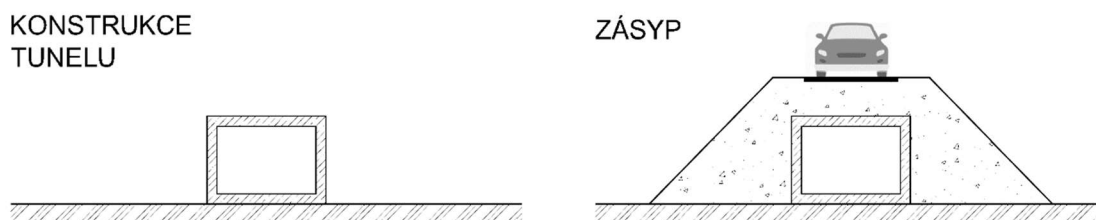
Obr. 19: postup výstavby přesypaných tunelů
