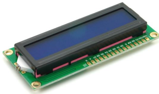
Obrázek 4.13: LCD display s integrovaným obvodem HD44780
