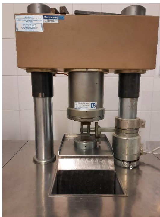
Obrázek 8: Zařízení pro měření pevnosti v tlaku
