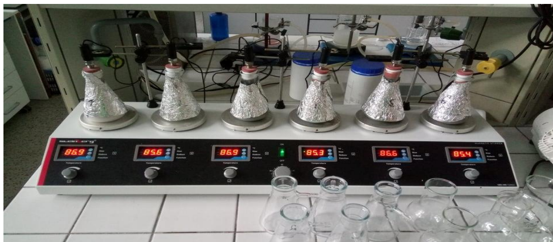
Obrázek 4: Magnetická míchačka pro Chapelluv test
