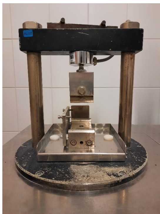
Obrázek 7: Zařízení pro měření pevnosti v tahu za ohybu
