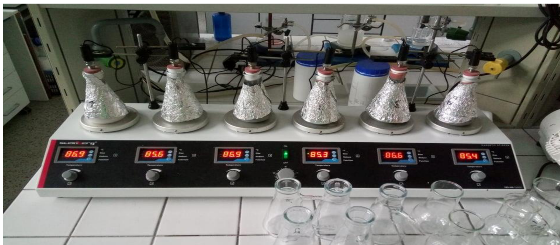
Obrázek 4: Magnetická míchačka pro Chapelluv test
