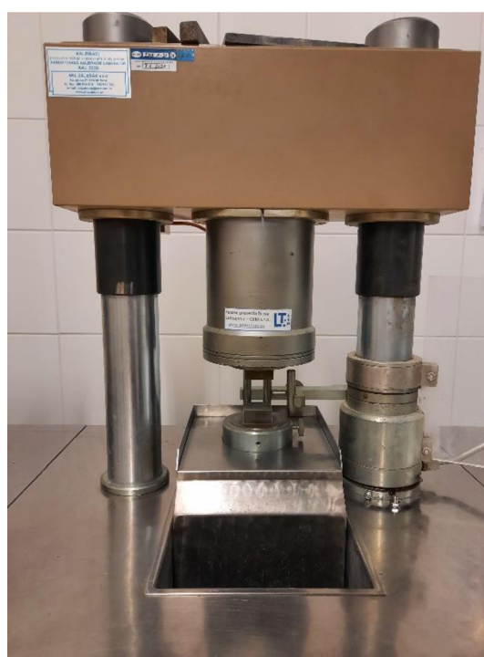
Obrázek 8: Zařízení pro měření pevnosti v tlaku
