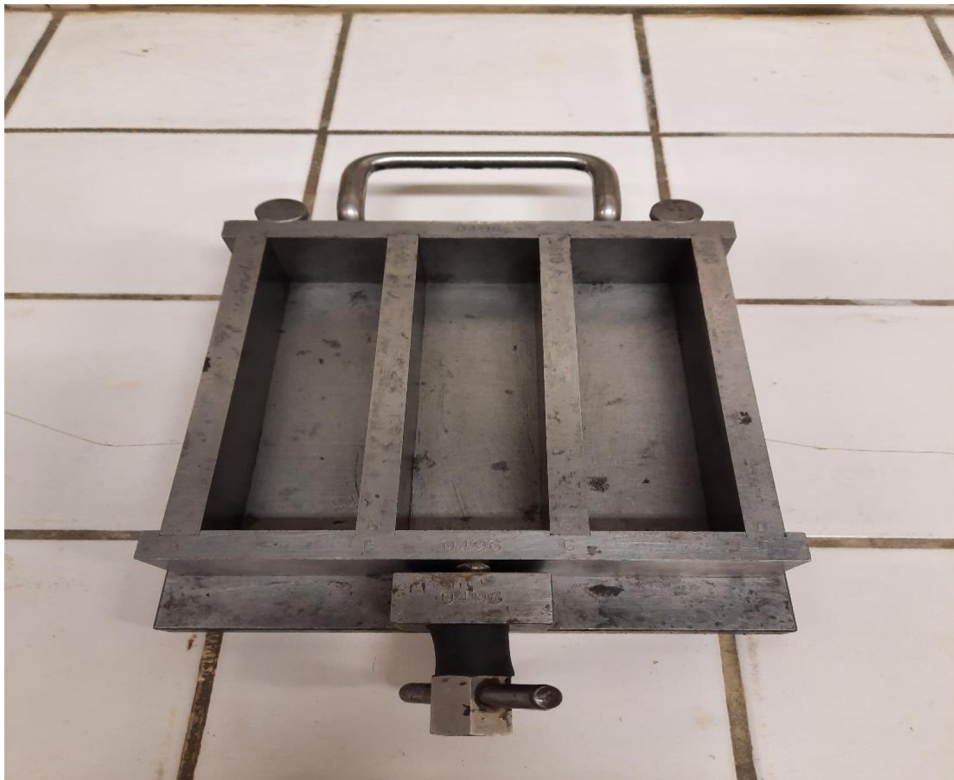
Obrázek 5: Ocelová forma s rozměry testovacích těles 40x40x160 mm
