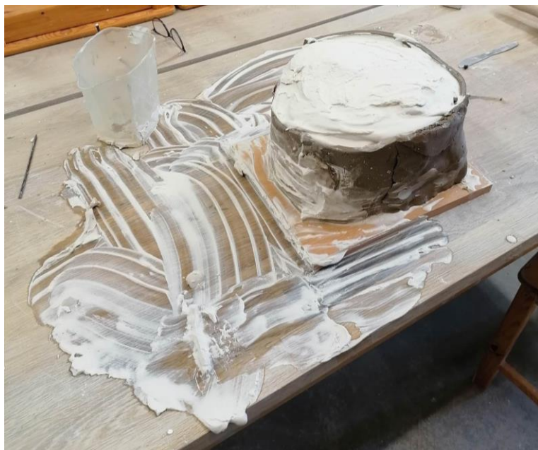
Obr. 29 – BULIČKOVÁ, Hana. Prasklá hliněná ohrádka na sádrovou formu. [keramická hlína, sádra, 2022]. archív autorky
