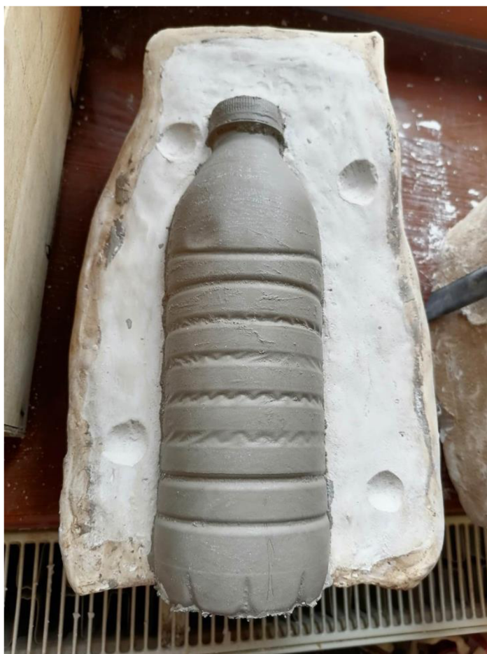
Obr. 31 – BULIČKOVÁ, Hana. Otevřená forma s výlitkem. [licí břecha, sádrová forma, 2023]. archiv autorky
