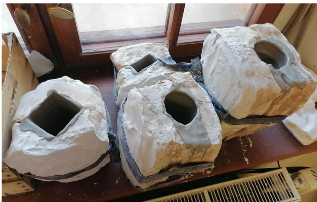
Obr. 30 – BULIČKOVÁ, Hana. Sušení výlitků ve formě. [licí břecha, sádrová forma, 2023]. archív autorky
