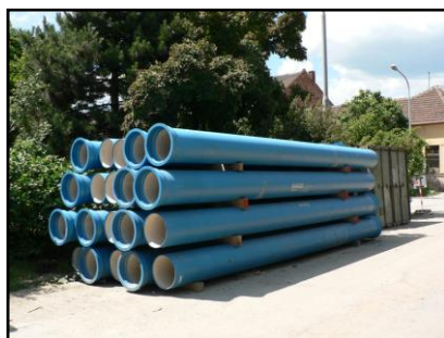
Obr. 6.2 - Trouby z tvárné litiny s cementovou výstelkou (URL 2)
