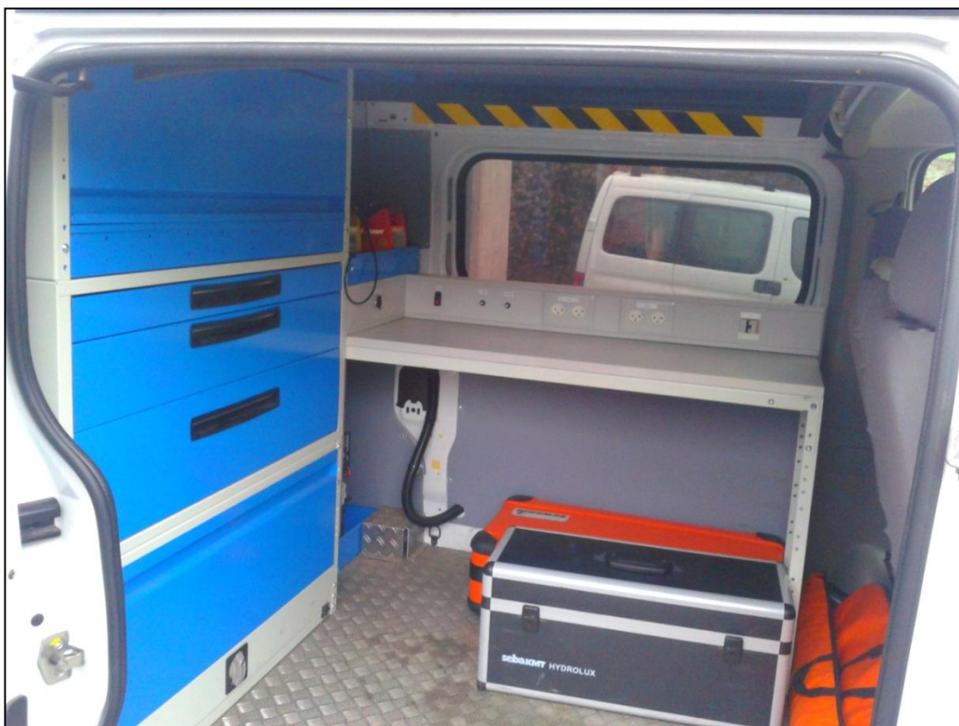
Obr. 3.6 - Vnitřek zásahového vozidla pro vyhledávání úniků ze sítě (autor práce 2014)
