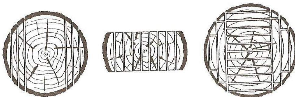
Obr. 3 Porez prizmovaním (Detvaj, 2003)
