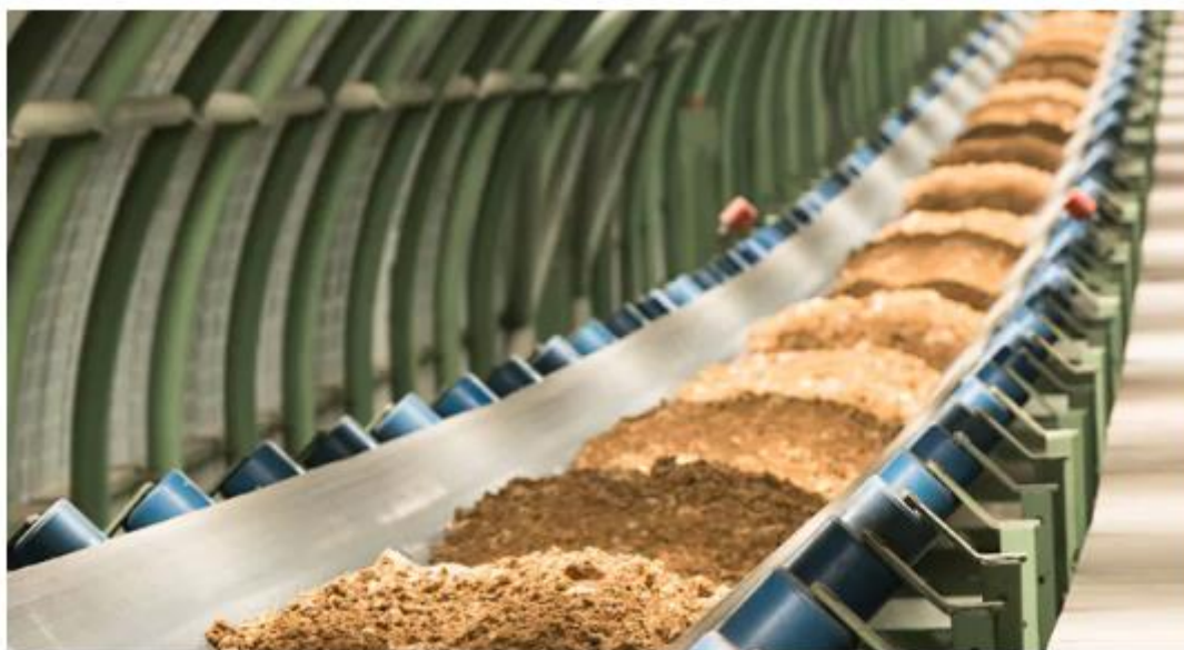
Obr. 1 Vodorovná doprava materiálu v dolech [3]
