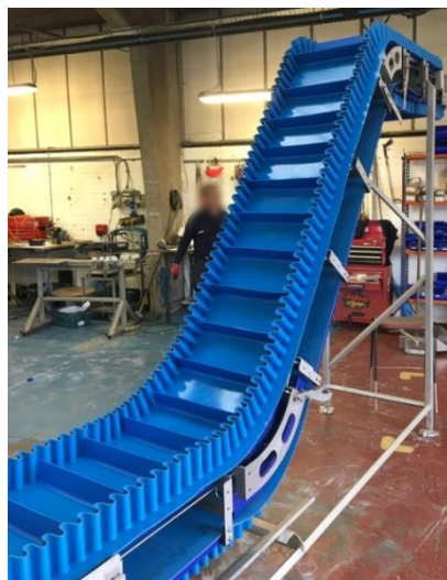
Obr. 5 Pásový dopravník se zvlněným bočním okrajem[6]
