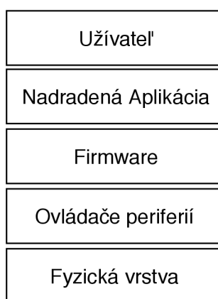
Obr. 5.1: Štruktúra softwaru diagnostického nástroja
