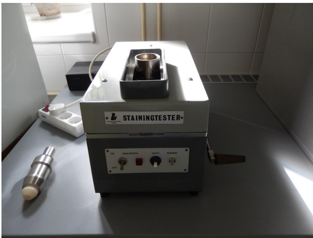
Obrázek č. 17: Stainingtester – přístroj na testování otěru
