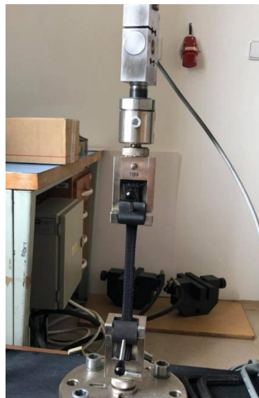
Obrázek 21. TIRAtest 2300- zkouška pevnosti švu
