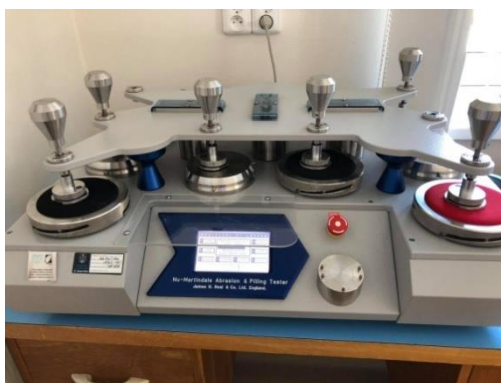
Obrázek 27. Zkouška oděru- Martindale
