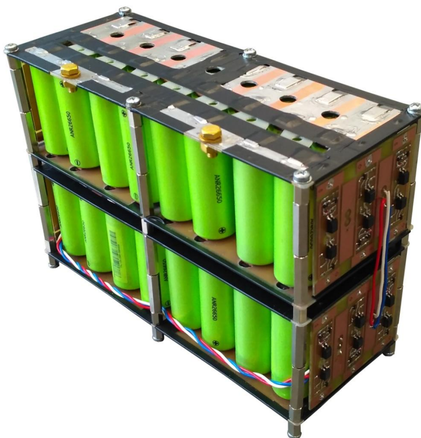
Obr. 0.4 Akumulátor s BMS obvody
