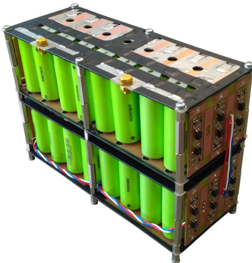
Obr. 0.4 Akumulátor s BMS obvody
