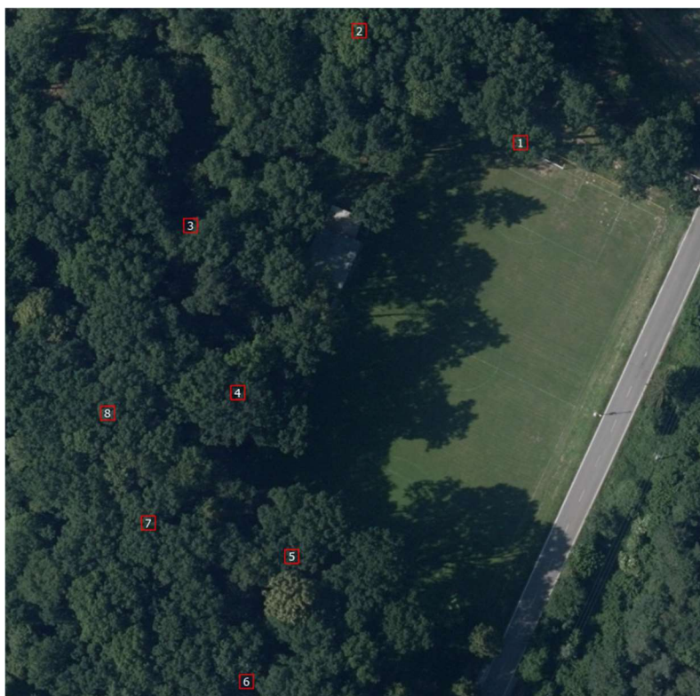
Obr. 21 Náčrt zobrazující plochy pro hodnocení průniku laserového paprsku (červené čtverce) včetně číselného označení jednotlivých ploch.
