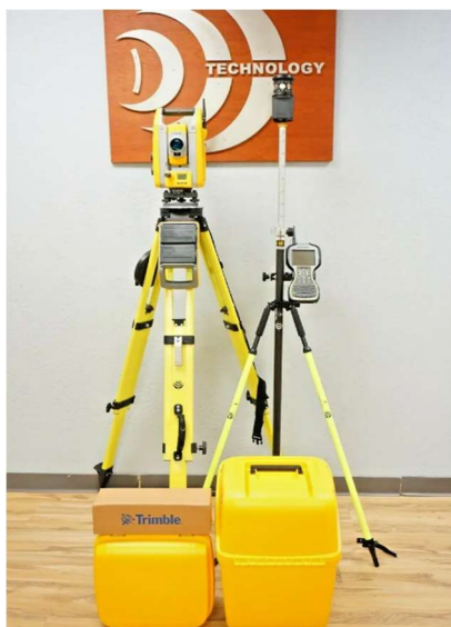
Obr. 2 Ukázka sady totální stanice Trimble S3 Robotic s 360° hranolem a ovladačem TSC3. Dostupné na: https://discountdays.ru/product/175349439943
