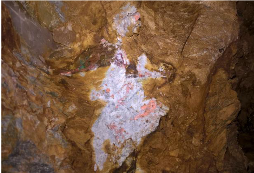
Obr. 6. Agregáty ryzí mědi v asociaci s jílovými minerály, vznikající v partiích postižených zvětráváním (foto: M. Petřek).
