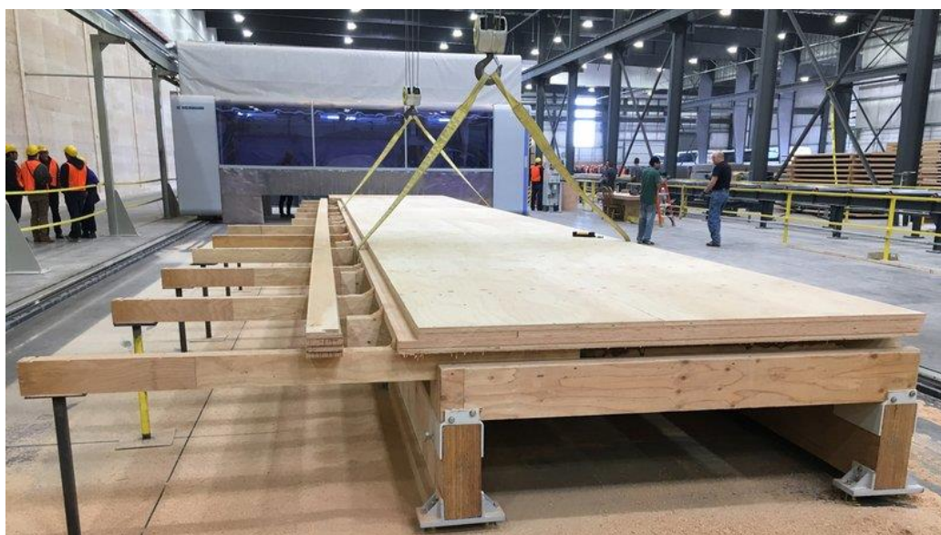
Obr. 24 MPP panel ve výrobě (Freres Lumber Co. Inc. 2021)
