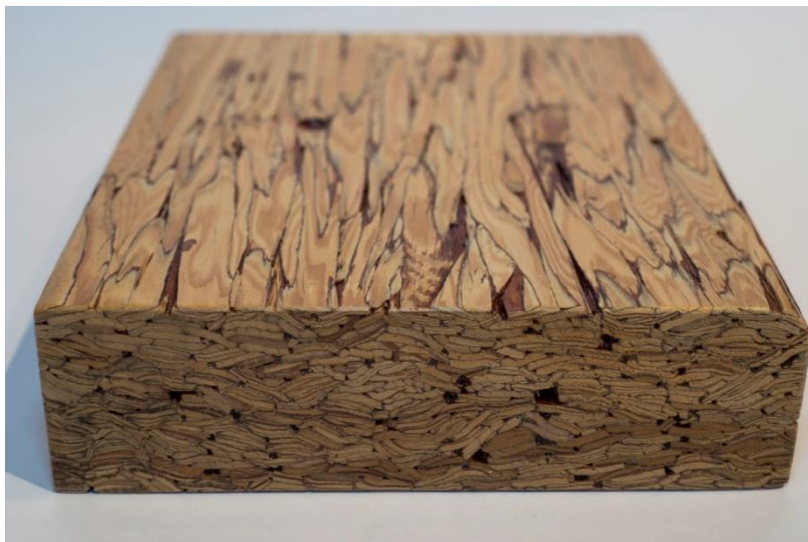
Obr. 19 Parallam – slisované pásky dřív (Fast + Epp GmbH 2021)
