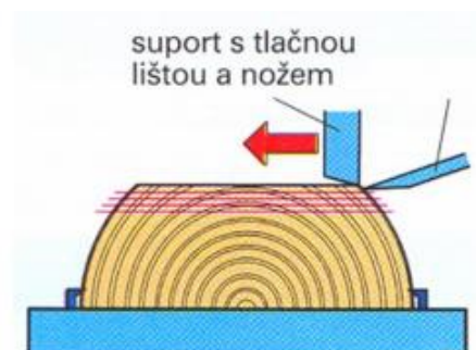
Obr. 17 Vodorovné krájení dýh (Drexlerová 2018)
