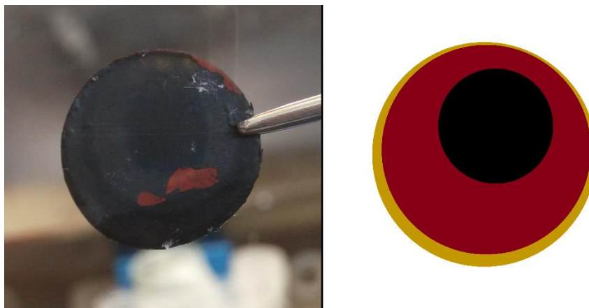
Obr. 2.13: Změna barvy elektrody po interkalaci
