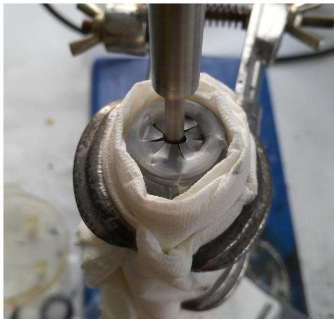
Obr. 2.9: Řešení utěsnění zkumavky pro míchání elektrodové pasty
