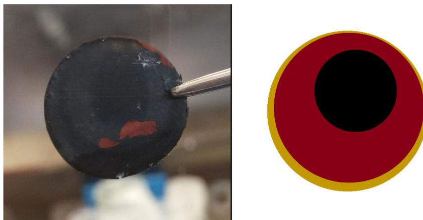
Obr. 2.13: Změna barvy elektrody po interkalaci
