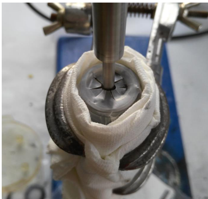
Obr. 2.9: Řešení utěsnění zkumavky pro míchání elektrodové pasty
