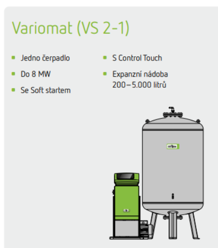
Obr. 89 – Expanzní automat Variomat - zařízení na udržování tlaku, odplyňování a doplňování [67]
