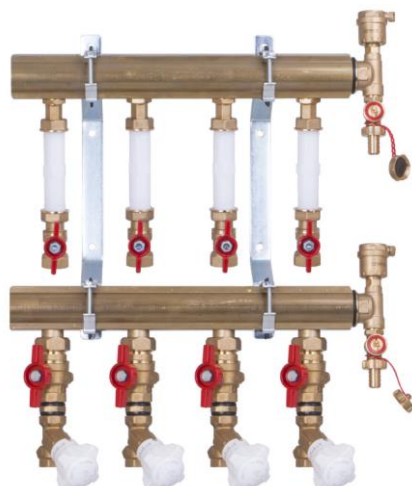
Obr. 21 - GE555-B - Patrový rozdělovač s měřením spotřeby tepla, kulové kohouty s otvorem M10 pro montáž čidla, vyvažovací ventil. [46]
