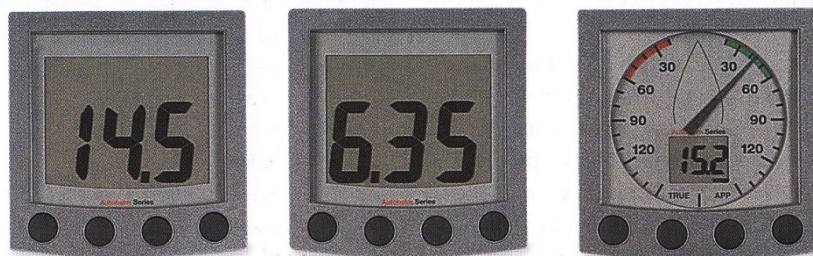
Obr. č. 10 Zobrazovací zařízení měřičů hloubky, rychlosti a větru. Zdroj: Sleight, S., 2002. Průvodce světem jachtingu , Knížní klub, Praha
