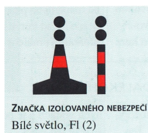
Obr. č. 9 Značka izolovaného nebezpečí
