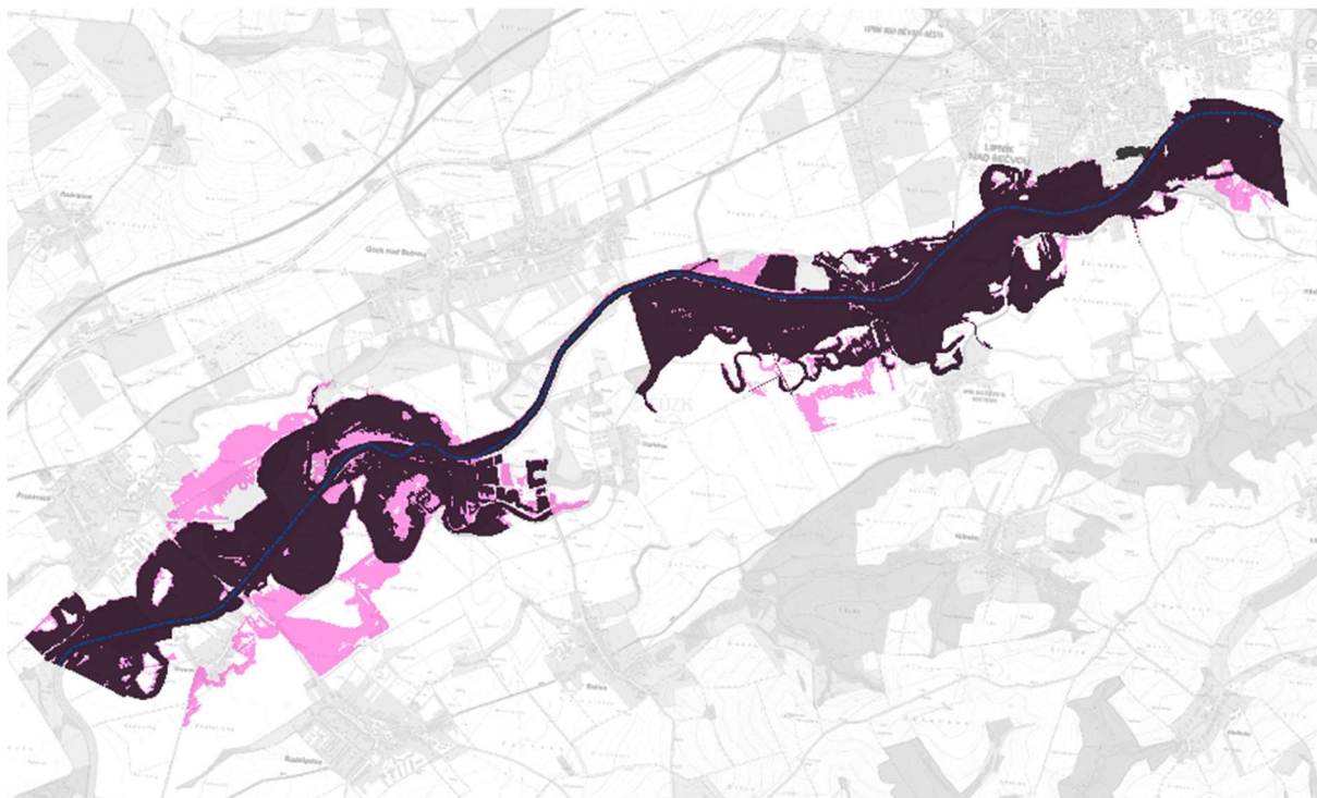
Obr. 60 – Porovnání rozlivů Q_{20} z variant A a B; modrá čerchovaná čára značí osu toku, růžová barva značí rozliv varianty A, tmavě fialová barva značí rozliv varianty B a tím pádem i překrytí rozlivů A a B (foto autor)
