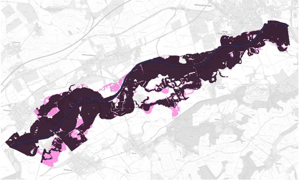
Obr. 62 – Porovnání rozlivů Q_{100} z variant A a B; modrá čerchovaná čára značí osu toku, růžová barva značí rozliv varianty A, tmavě fialová barva značí rozliv varianty B a tím pádem i překrytí rozlivů A a B (foto autor)
