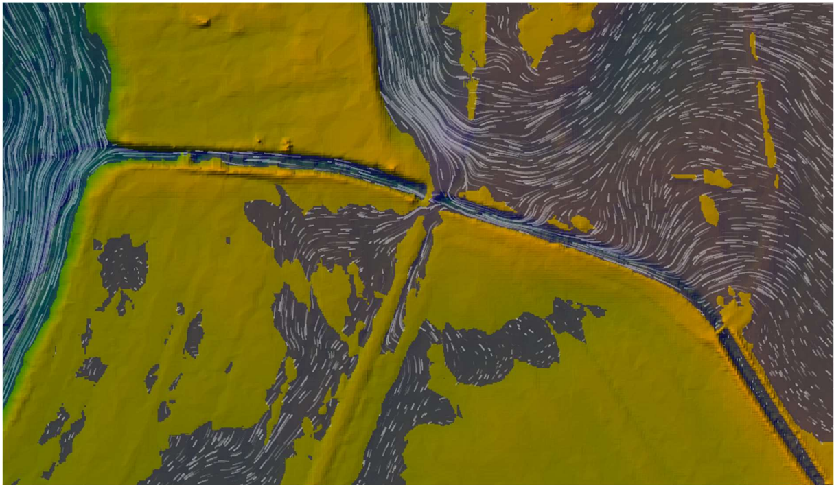
Obr. 35 – Půdorysný pohled na nedokonale vymodelovaný most v oblasti inundace, simulace Q_{100} , varianta A; tok teče zprava doleva, bílé čáry značí směr a velikost vektorů rychlostí, modrá plocha značí vodní hladinu (foto autor)
