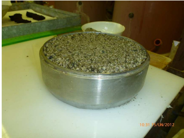
Obr. 4-3 Filtrační materiál struska
