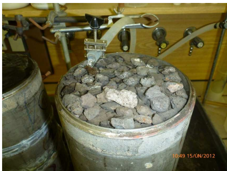
Obr. 6-2 Filtrační materiál – struska 8-16mm
