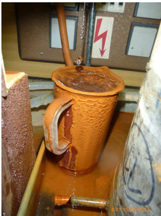
Obr. 6-4 Koroze železných kuliček materiálu Velké tryskače
