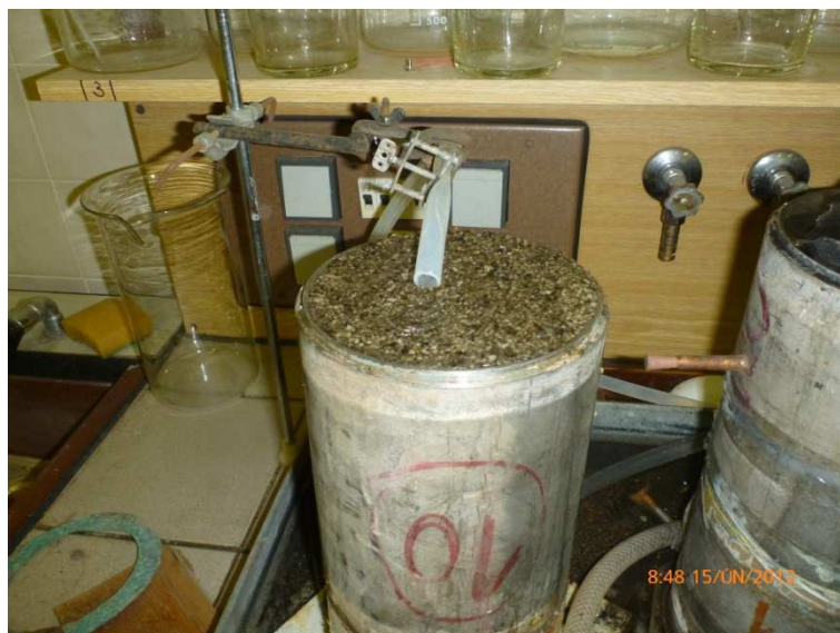
Obr. 6-1 Filtrační materiál – struska
