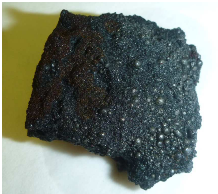
Obr. 6-4 Koroze železných kuliček materiálu Velké tryskače
