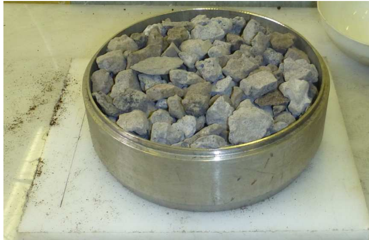
Obr. 4-14 Filtrační materiál – struska 8-16 mm (Dekonta)
