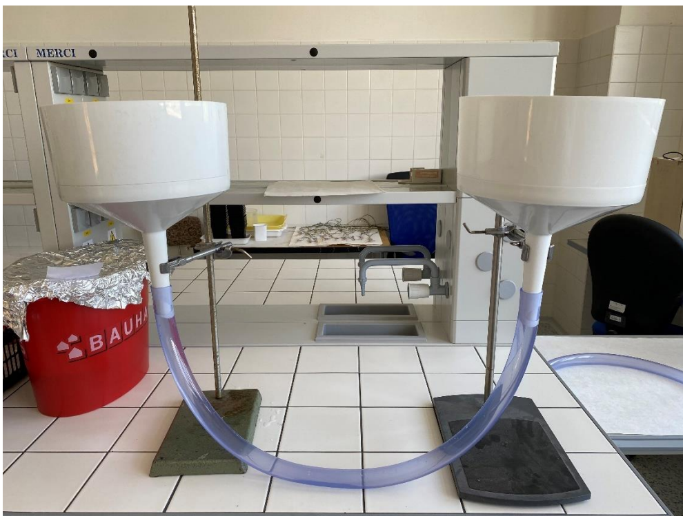
Obrázok 11: aparátúra používaná na izoláciu pôdneho gélu z pôdnej matrice
