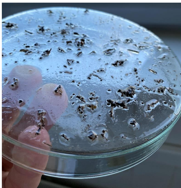
Obrázok 12: izolovaný pôdny gél z pôdnej matrice černoze; možno vidieť vysoký obsah hrubých nečistôt
