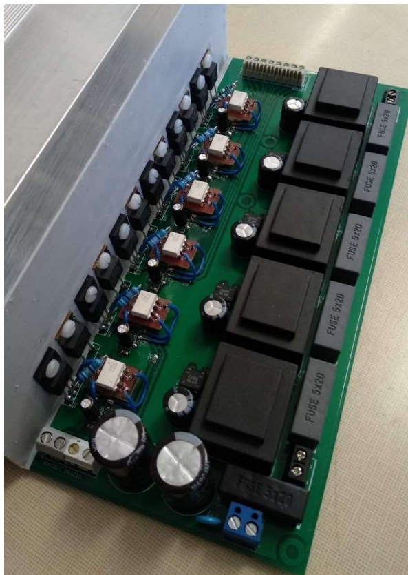
Obrázek 28 Osazená DPS silové části proudového střídače
