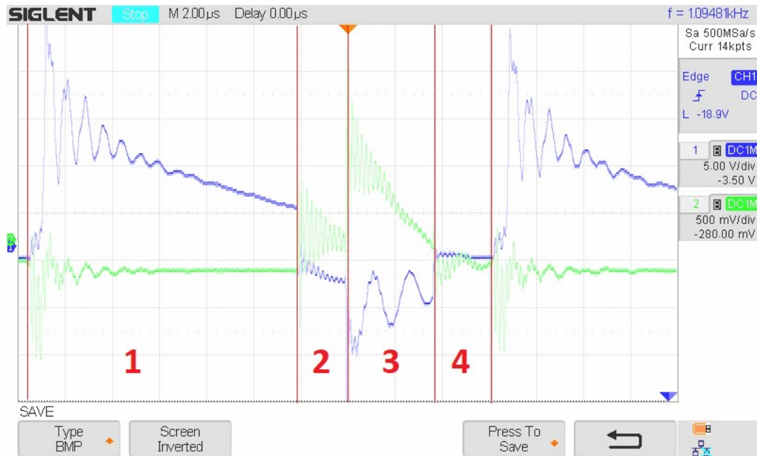
Obrázek 37 Průběh napětí a proudu v jedné větvi střídače
