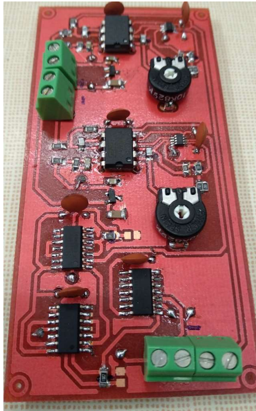
Obrázek 29 Osazená DPS PWM generátoru
