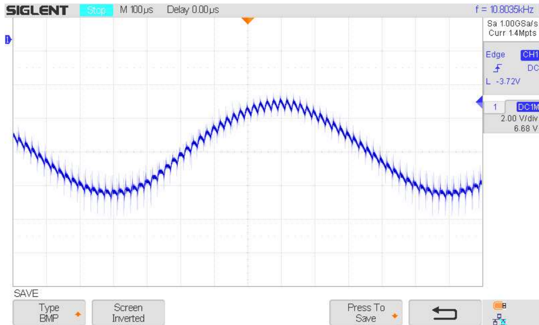
Obrázek 38 Výstupní napětí na zátěži 1
