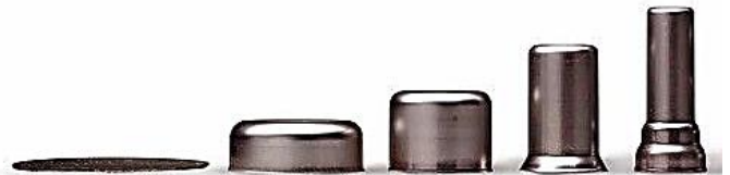
Obr. 12 Proces ťahania rotačného výťazku [23]
