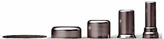
Obr. 12 Proces ťahania rotačného výťazku [23]
