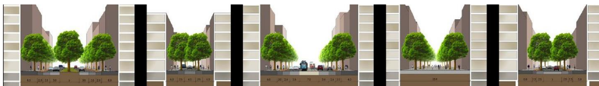
Obrázek 4: Různé příklady traktování uličního profilu zelení - zleva: stromořadí vytváří čtveřici dílčích prostorů; zezeň vytváří trojici dílčích prostorů; zezeň vytváří dominantní dopravní koridor; zezeň vytváří dominantní koridor pro pěší pohyb; zezeň vytváří trojici dílčích prostorů (Pavel Hnilička architekti, 2010)
