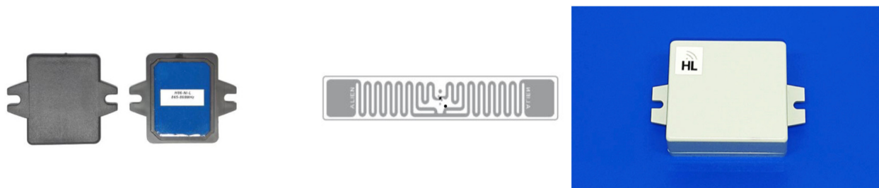
Obrázek 7.2: UHF tagy. Zleva: HL UHF RFID tag na nekovový podklad, Alien Squiglette Inlay ALN-9630, HL UHF RFID Stock 3 – na kovový podklad. Zdroj: www.hl-rfidtag.com , www.shopid.cz
