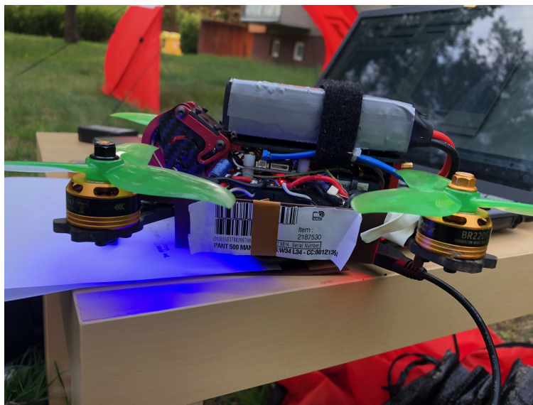
Obrázek 8.3: Umístění RFID tagu na testovacím dronu.
