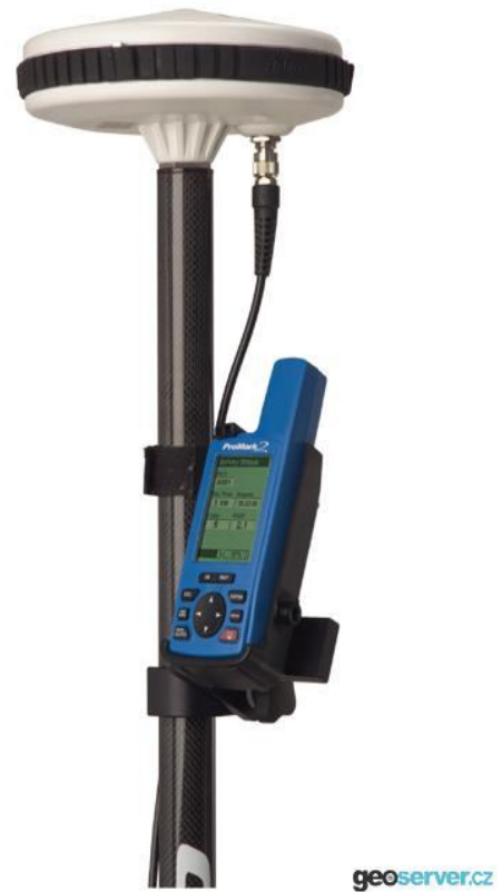
Obr. 4.3 Meračská aparatúra pre metódu GNSS [upraveno 23]
