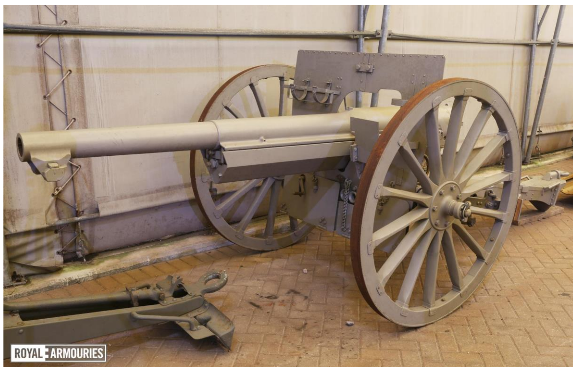
Obr.5 Francouzské 75 mm polní dělo s hydropneumatickým mechanismem [7]
