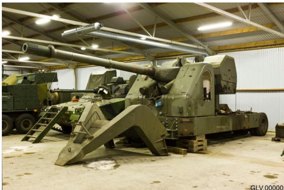
Obr.2 Velkorážné dělo s kompenzátořem zdvihu [2]
